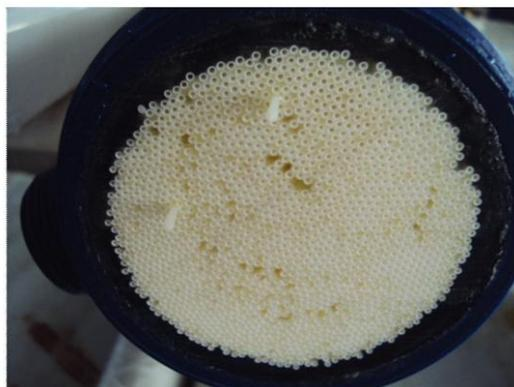
超滤膜组件使用一段时间后,当发现产水水质下降时,应对组件进行完整性检测,查出并修补出现问题的组件,无法修补的应进行更换。
